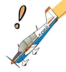
La tension appliquée au câble est telle que le largage est impossible, tant du côté planeur, que du côté avion.
